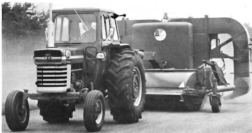
Sopblåsmaskinen i arbete sommartid: Här sopar och blaser den bort skräp från banan. På samma sätt tar den hand om snö, dock ej is.
